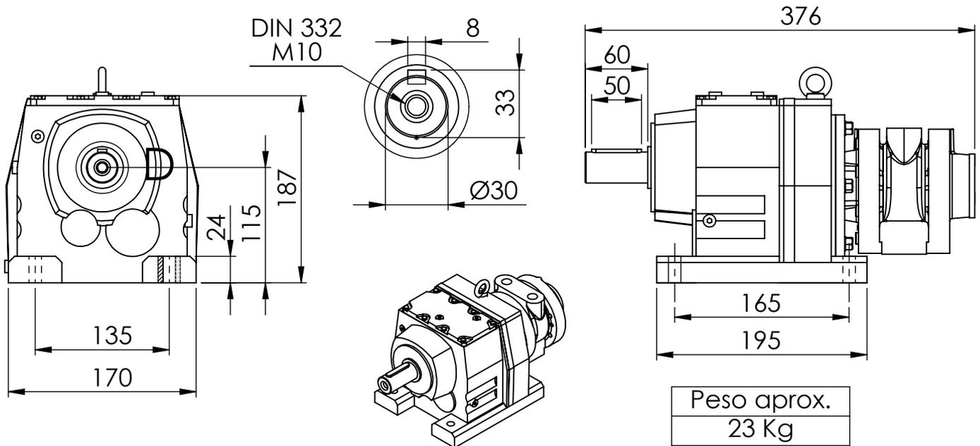
Motoredutor pneumático de palheta reversível tipo XMP4 RF47 00 (redução 1:XXX)
