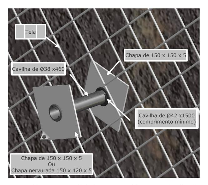
Quando temos necessidade de que se estabiliza uma rocha alterada, com a colocação de uma tela metálica. Este sistema consiste, logo após a furação instala-se imediatamente antes da deformação do furo a cavilha Ø42, com ou sem chapa, conforme a necessidade.
